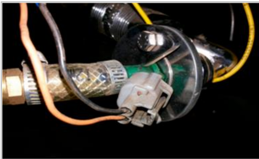
Figura 5. Instalación de un inyector de etanol en un colector de admisión [10]
