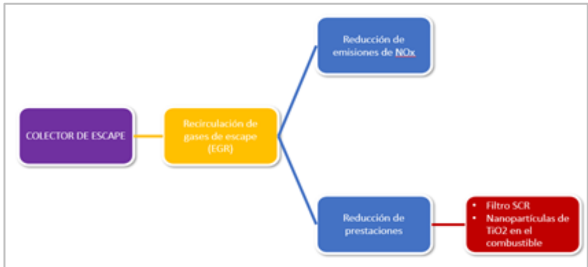
Figura 12. Diagrama esquemático de modificaciones del colector de escape [32]
