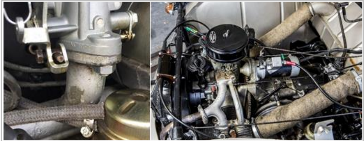
Figura 1. Condensación en el colector de admisión en la fotografía de la izquierda debido al calor absorbido por la gasolina en su vaporización en el carburador. Solución implementada en la fotografía de la derecha basada en conectar el colector de escape con el de admisión, evitándose así la congelación
