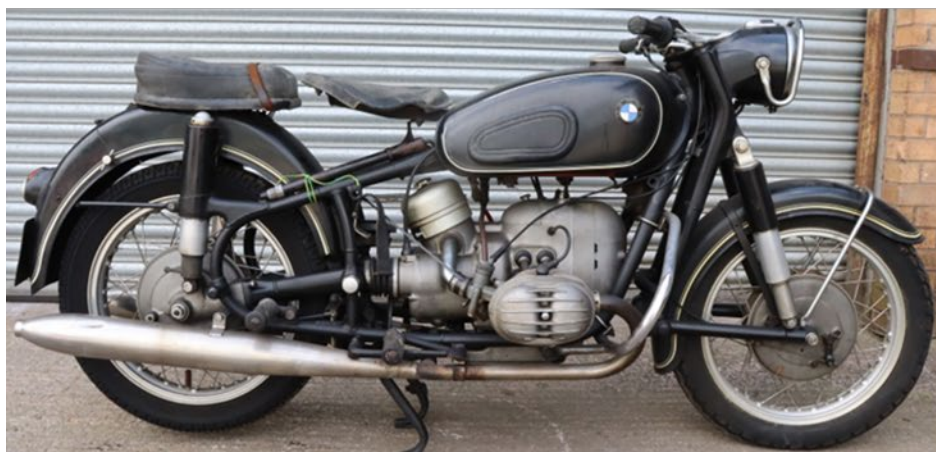
1960.- BMW R69 (R. F. Alemania) 594 cm 3 - 42 CV a 7000 rpm
