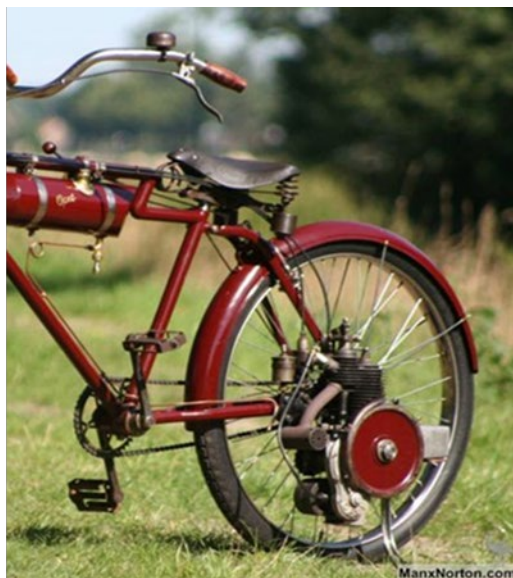
1922.- Opel (Alemania) 140 cm 3 – 1,6 CV – Bicicleta con motor
