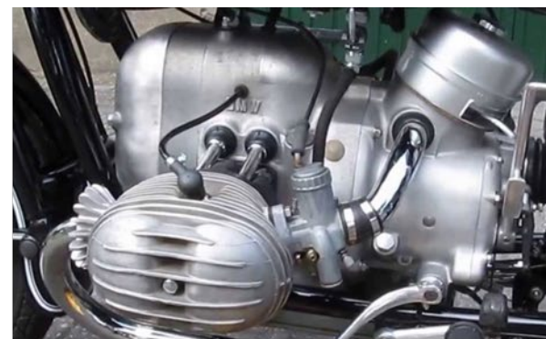
1960.- BMW R69 (R. F. Alemania) 594 cm 3 - 42 CV a 7000 rpm
