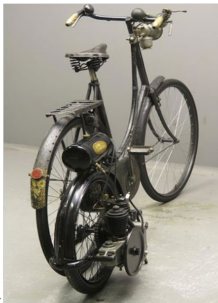
1922.- Opel (Alemania) 140 cm 3 – 1,6 CV – Bicicleta con motor
