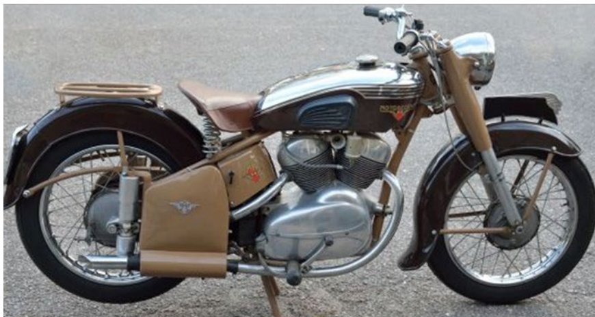
1961.- Bultaco Mercurio 155 155 cm 3 – 4 CV a 5000 rpm
