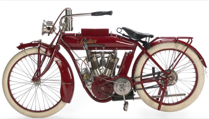
1912 Indian Twin (EE. UU.) 988 cm 3 - 7 CV - 2 marchas - arranque por pedal
