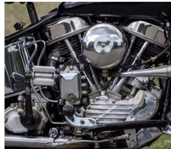
1949- Harley & Davidson FL Hydra Glide (EE. UU.) 1208 cm 3 - 55 CV a 4800 rpm (V a 60°)
