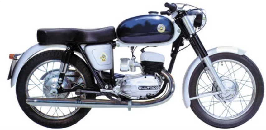
1961.- Bultaco Mercurio 155 155 cm 3 – 4 CV a 5000 rpm
