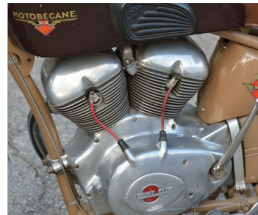
1947.- Motobécane 350 V4C (Francia) 350 cm 3 – 17 CV a 5000 rpm (V a 60 °)
