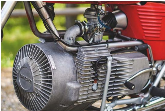
DKW W2000 de 1974. Motor Sachs de 1 rotor
