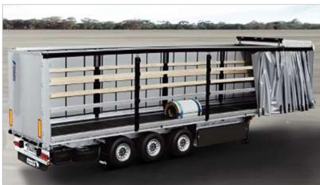
En España un semirremolque con laterales de lona es un "lonas", mientras que en Francia o UK es de cortinas (rideaux, curtains)
