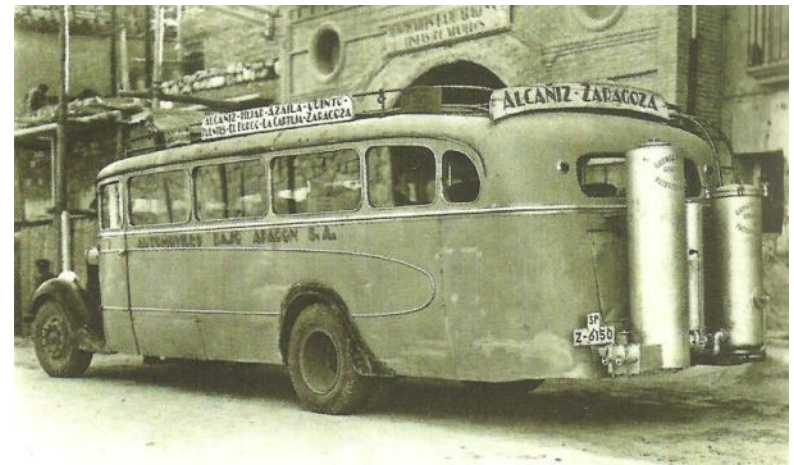
Camiones y autobuses transformados a gasógeno. 1942
