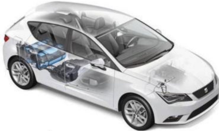
Montaje de los depósitos bajo el piso en las versiones CNG de los SEAT León y SEAT Mii
