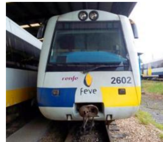
Tren de la serie 2600, transformado a GNL
