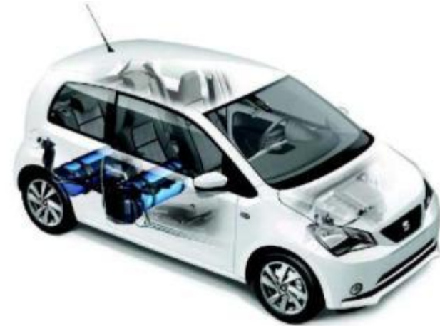
Montaje de los depósitos bajo el piso en las versiones CNG de los SEAT León y SEAT Mii
